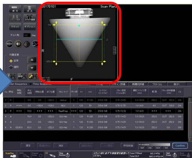
RealPrep使用時には、S&V撮影直前の開始ランプ点灯時に再構成が停止しますが、[Scan Plan]を押すことでスキャン計画画面に戻り、再構成もリスタートさせることができます。
